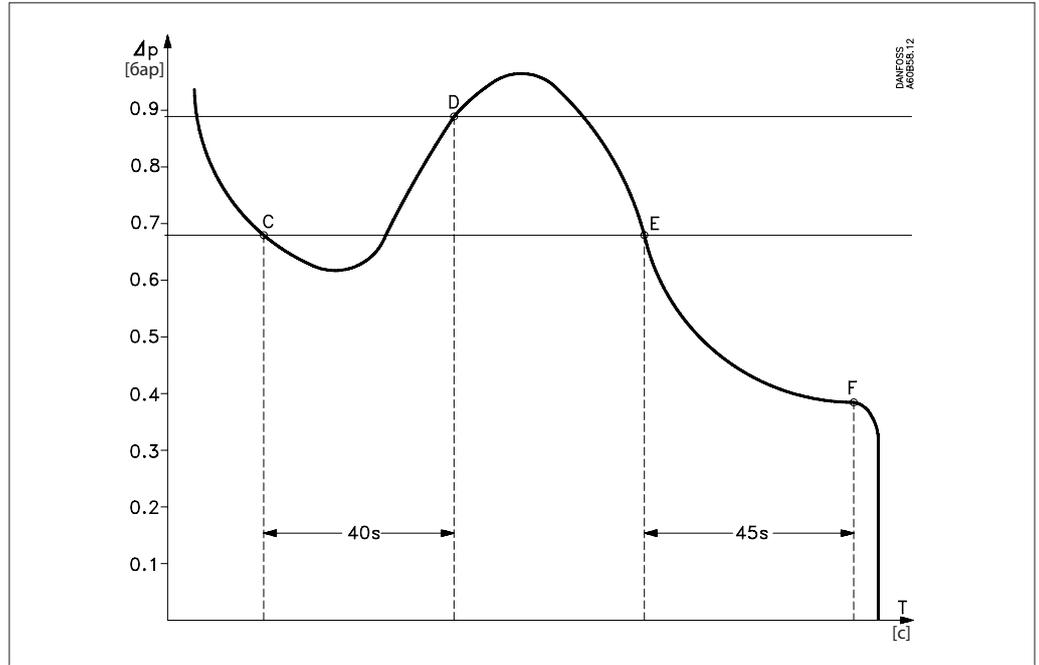
**Поз. С:** давление смазочного масла падает во время работы до значения ниже установленного/фиксированного перепада давления. В точке С цепь безопасности T1-T2 включается и реле времени активируется.
