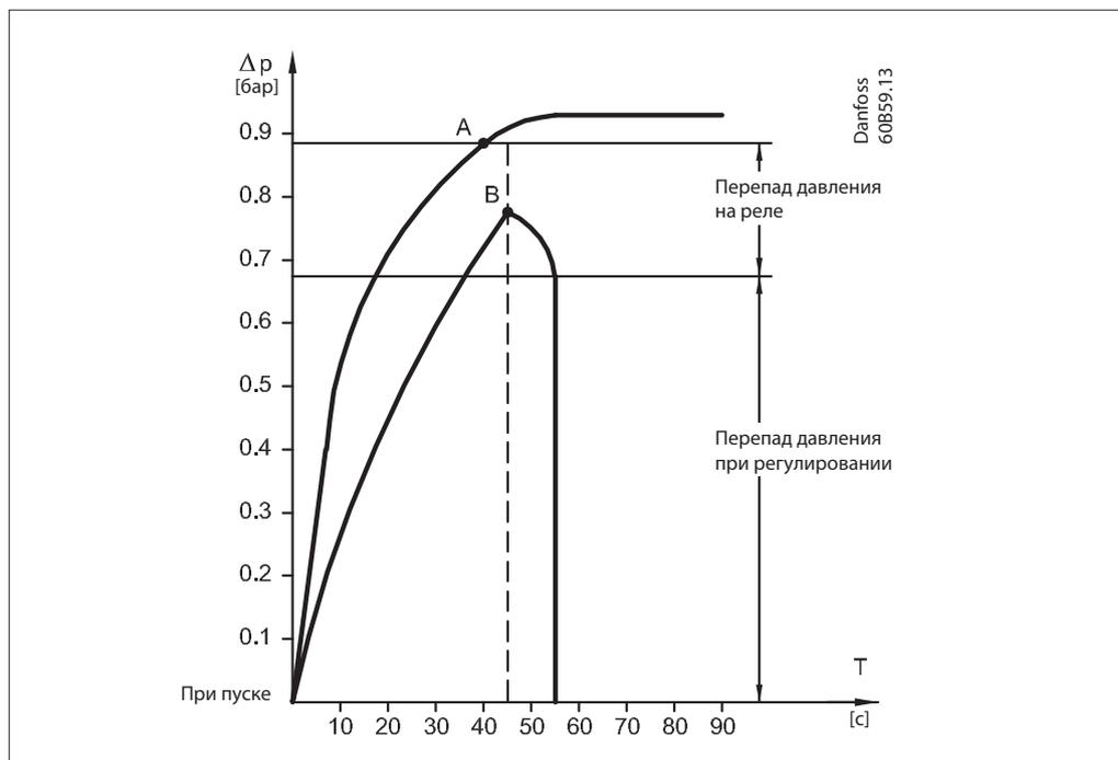
**Поз. А:** нормальный пуск. Давление смазочного масла повышается во время пуска до установленного/фиксированного перепада давления плюс дифференциал контактов перед тем, как реле времени выключается (в данном примере через 45 секунд). В точке А контакты T1-T2 открываются и реле времени (e) останавливается, т. е. были обеспечены нормальные условия смазочного масла для компрессора.
