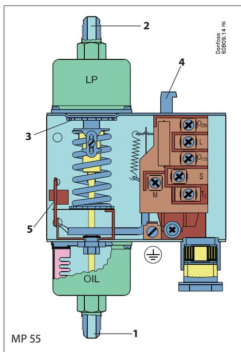
Работа реле давления зависит только от перепада давления, т. е. разницы давления между двумя противодействующими сильфонами, при этом она не зависит от абсолютного давления, действующего на оба сильфона.
